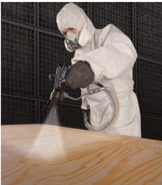
Abb. A10-2 Manuelles Beschichten von Holzplatten mit luftzerstäubender Handsprüheinrichtung für wasserverdünnbaren Flüssiglack (Außenaufladung)
